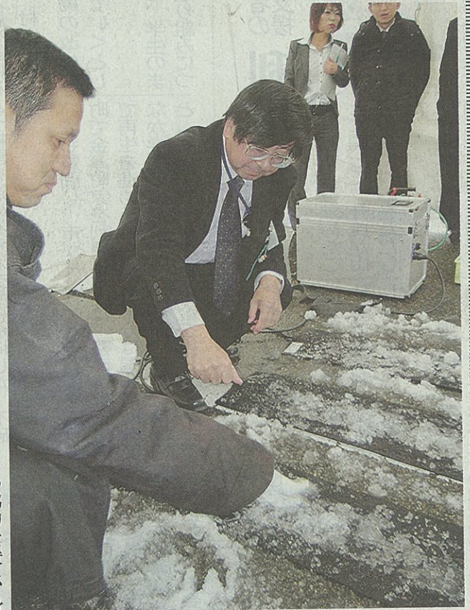
水素エネルギーを活用した融雪マットの効果を確認する鈴木教授(右)ら＝金沢市赤土町で
